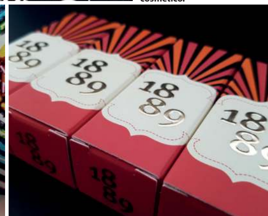
La Scodix Ultra Pro con Foil usata da Intercosmografica per la nobilitazione digitale di astucci per il settore cosmetico.
